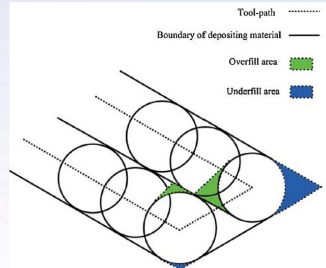
Overfill and underfill
